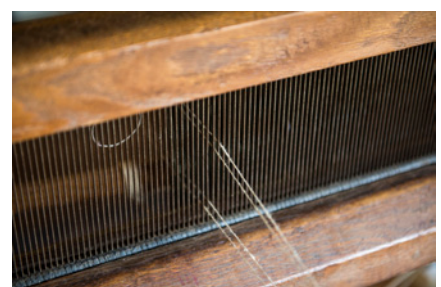
Detail van het riet uit het weefgetouw, waardoor de hennepdraden worden geleid om zeildoek te kunnen weven.
